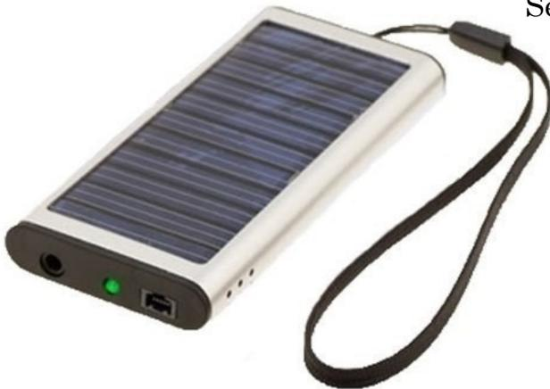
Um brinquedinho eletrônico barato e que pode ser útil em situações de emergência: um carregador solar, de pequenas dimensões, capaz de fornecer 12 volts por 1 Amper! Se estiver correto essa capacidade de corrente, ideal para carregar uma bateria selada de 12 volts para sua estação. Claro, precisa de sol brilhante para pleno fornecimento de eletricidade. Preço desta maravilha: 40 reais no [www.mercadolivre.com.br](http://www.mercadolivre.com.br)
