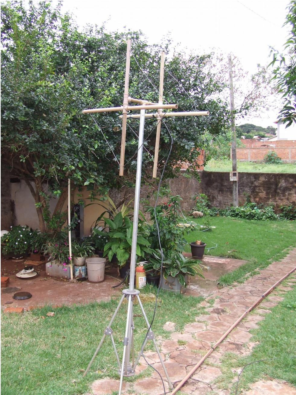
Nesta foto vemos uma antena Quadra Cúbica para 144 MHz, de alto ganho. Por ser construída em PVC, ela torna-se bastante resistente às intempéries e é fácil de ser carregada. Neste caso, não usamos cola para fixar os dois quadros, permitindo assim que ela possa ser desmontada e levada no porta-malas do carro. A parte do suporte, onde estão o “T” e a cruzeta estão sim, colados com cola própria para PVC “soldável”
