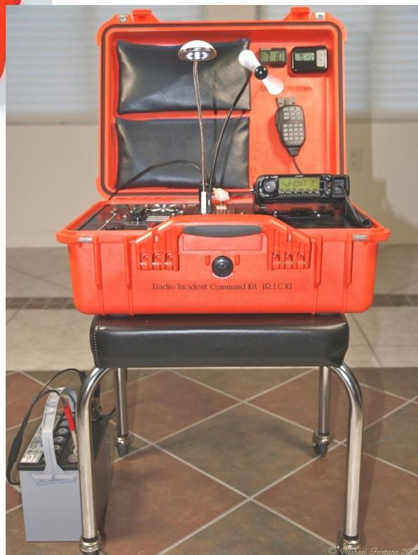
Vemos aqui algumas maletas de plástico e hermeticamente fechadas, capazes de armazenar tudo aquilo que um radioamador precisa em uma emergência. Vejam que os kits variam, dependendo da situação, mas praticamente todos são compostos de transceptores portáteis, baterias e diversos outros acessórios. Fotos baixados do site: <http://emergencyradiogokit.com>
