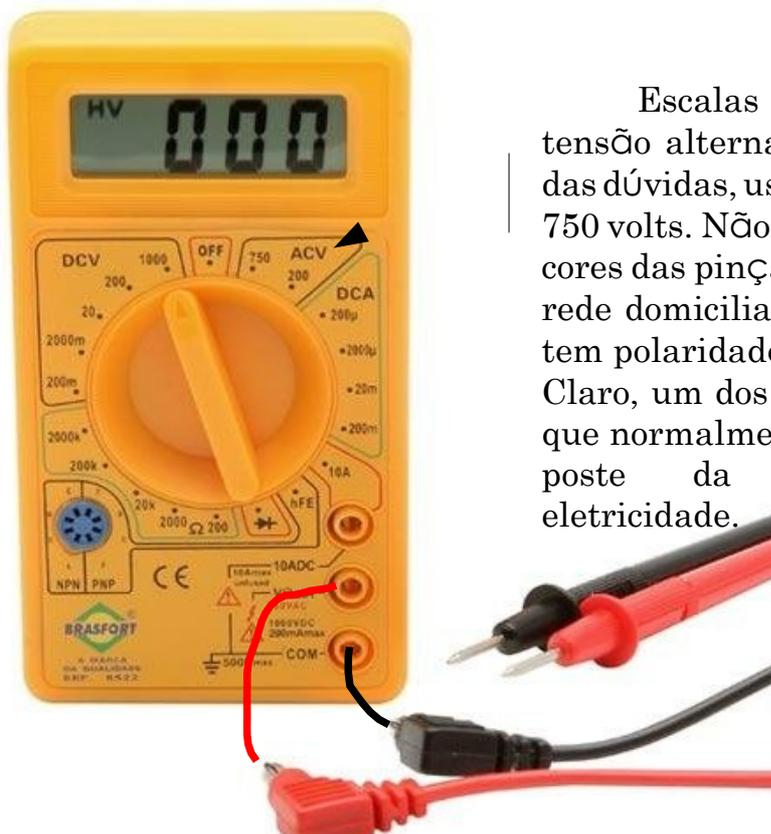
Escalas para medida de tensão alternada (ACV). Por via das dúvidas, use a escala maior, de 750 volts. Não se preocupe com as cores das pinças, pois a tensão da rede domiciliar é alternada, não tem polaridade para fins de teste. Claro, um dos fios é o NEUTRO, que normalmente vai aterrado no poste da companhia de eletricidade.
